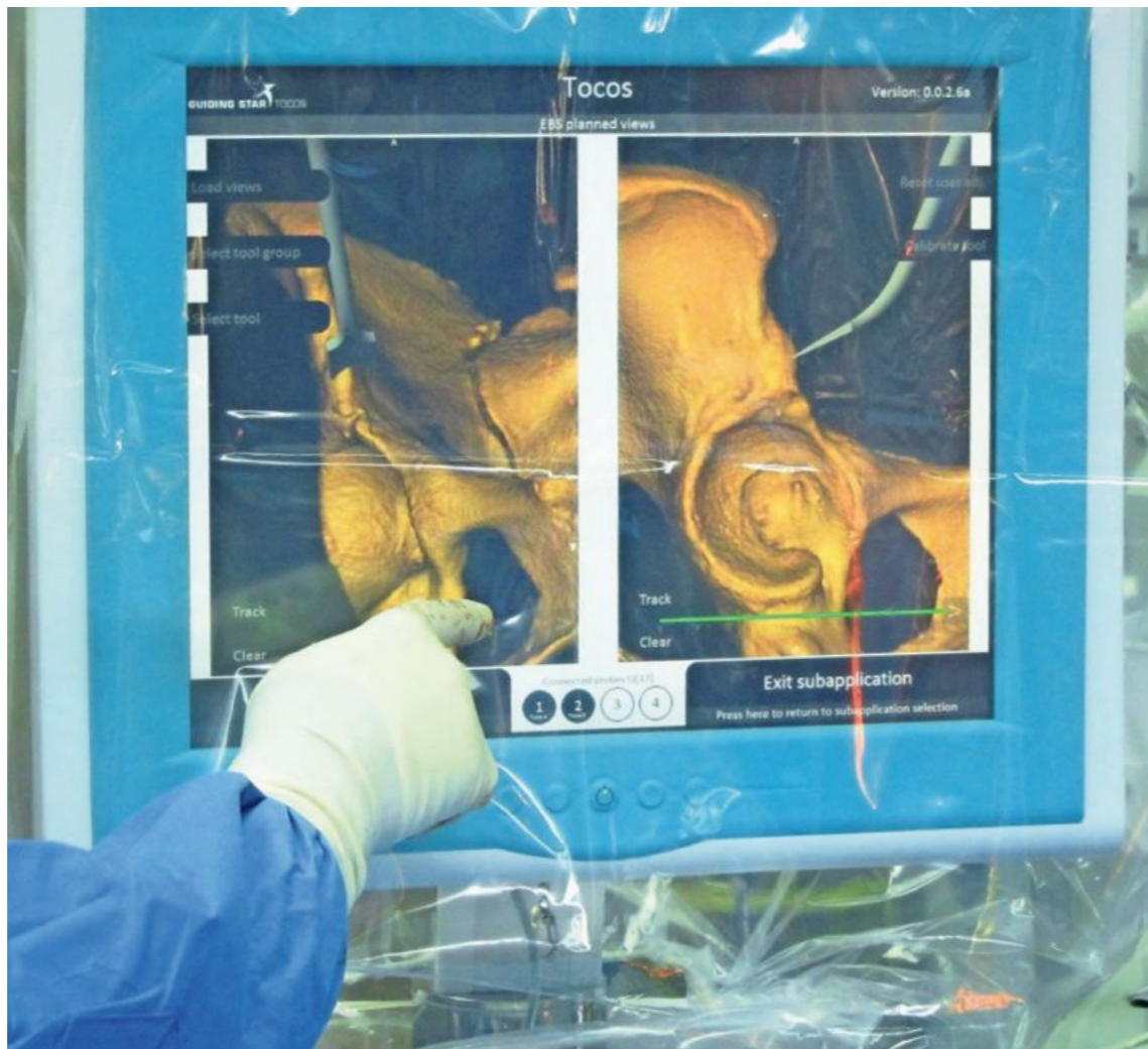
Izvedbo osteotomije preverimo na monitorju navigacijske naprave s 3D-pogledom. FOTOGRAFIJI ORTOPEDSKA BOLNIŠNICA VALDOITRA
